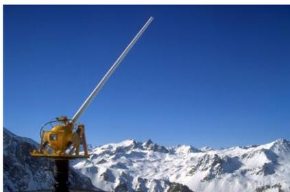
Der französische Avalancheur, eine Gasdruckkanone ähnlich dem amerikanischen Avalancheur kompensiert das Problem der schlechten Zünder Eigenschaften durch die Verwendung eines langen schlanken Projektils damit die Detonation zumindest teilweise an oder über der Schneedecke erfolgt. Zudem wird ein Zweikomponenten-Sprengstoff eingesetzt, damit man die strengen gesetzlichen
