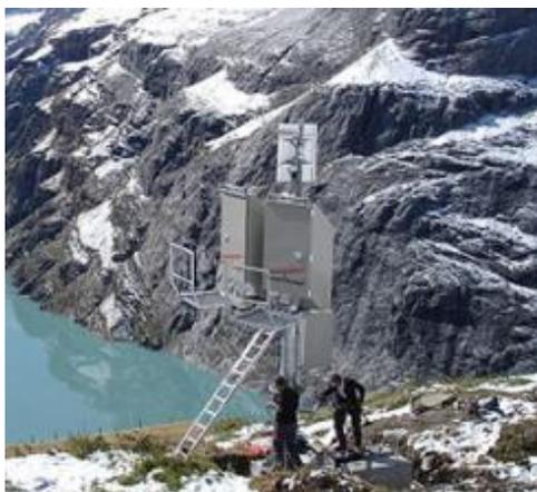
Solarpanels eine Batterie geladen. Die Bedienung erfolgt ebenfalls über Funk von einem PC in einer Kommandozentrale.
