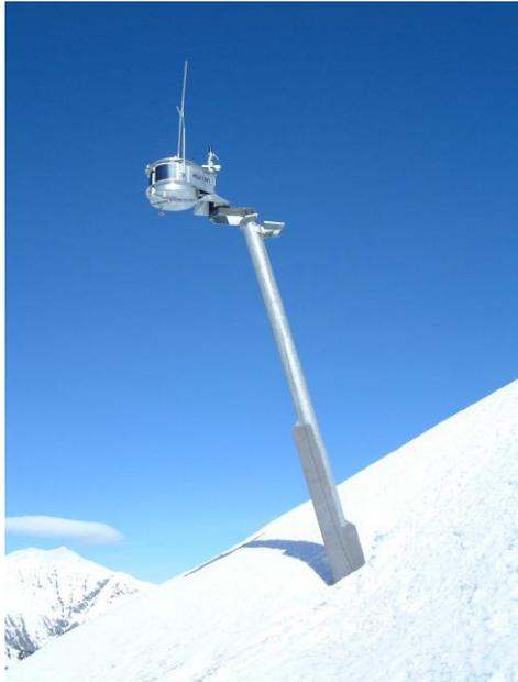
Lawinensprengmasten werden ähnlich wie die Gazex® Anlagen innerhalb des obersten Abschnitts eines Anrissgebietes oder auf Rippen zwischen Couloirs oder Anrissmulden installiert. Lawinensprengmasten wie der Wyssen - Sprengmast sind ebenfalls ferngesteuert und senken 5 kg schwere Sprengladungen auf eine optimale Sprenghöhe ab bevor diese detonieren.
