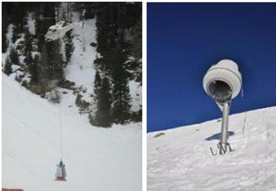
Neue Entwicklungen vom selben Hersteller wie Gazex® sind Daisybell® und O'Bellx®. Eine Gasmischung (Wasserstoff/Sauerstoff) wird in einem glockenförmigen Behälter gezündet. Die Daisybell® wird mit einer Leine am Hubschrauber angehängt, zum potentiellen Lawinenanrissgebiet transportiert und im stationären Flug ausgelöst. Die Zündung wird vom Helikopter aus ausgelöst und die
