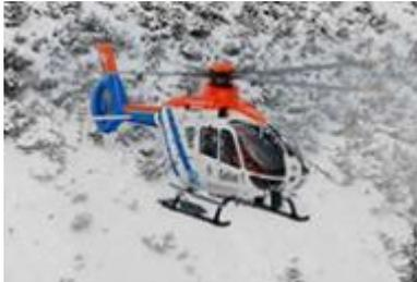
Helikoptereinsätze für die künstliche Lawinenauslösung sind eine weit verbreitete, sehr günstige und effiziente Massnahme. Um die Gefahr von Blindgängern zu minimieren werden müssen die Wurfladungen mit zwei Zündmittel versehen werden. Abgesehen von rechtlichen Einschränkungen für den Abwurf von Sprengladungen vom Helikopter in gewissen Ländern hat diese Methode drei grundsätzliche
