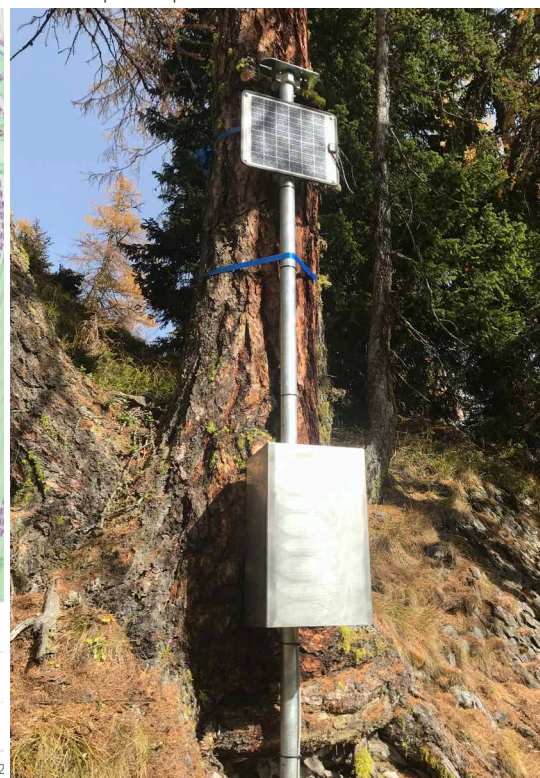
Installasjon av GINA® Styringsenhet og Solcellepanel på et tre
